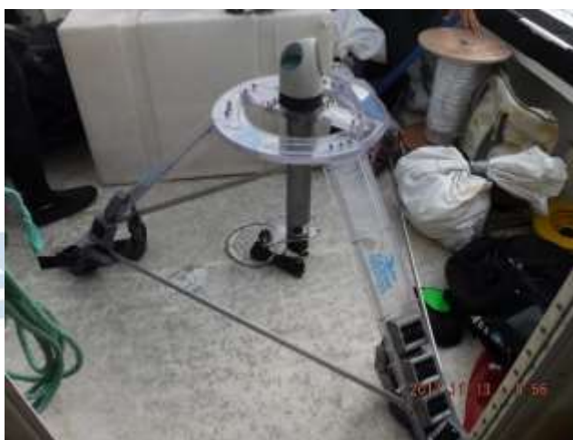
Figura 3.- Estructura piramidal de acrílico/metal con perfilador y pesos muertos.
