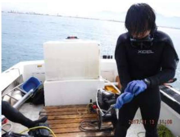
Figura 7.- Tarima con motor y bomba de agua a presión. Al centro sobre la tapa del motor de la embarcación, contenedor de agua para el sistema de bombeo.
