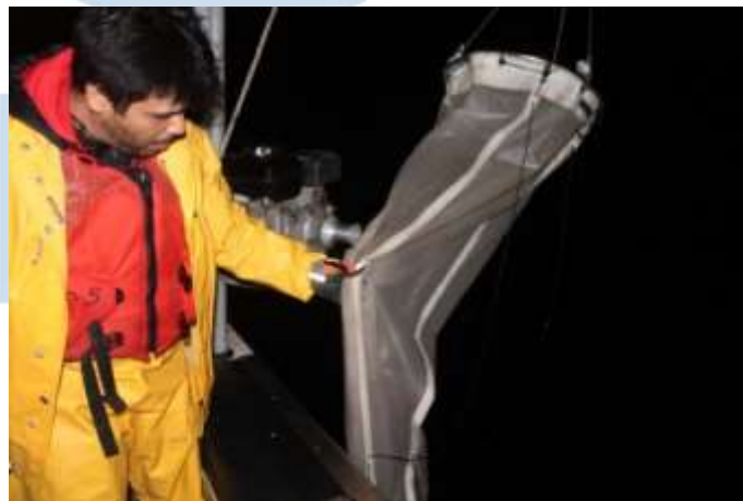
Fig. 4.- Red cónica de 50 cm de diámetro por 2.5 m largo y malla de 333 micras.
