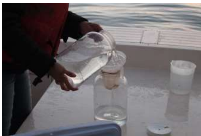
Fig. 3.- Filtración de agua de mar con cedazo de 140 micras.
