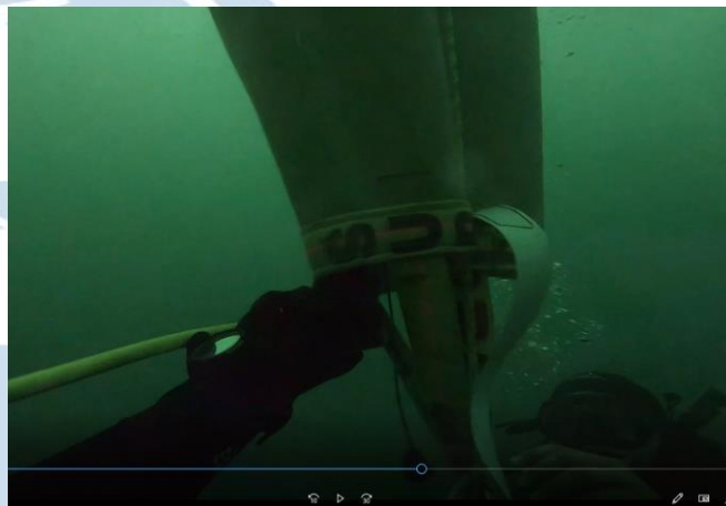
Figura 14.- Inflando la bolsa para mover el SIGNATURE en el fondo marino. MR
