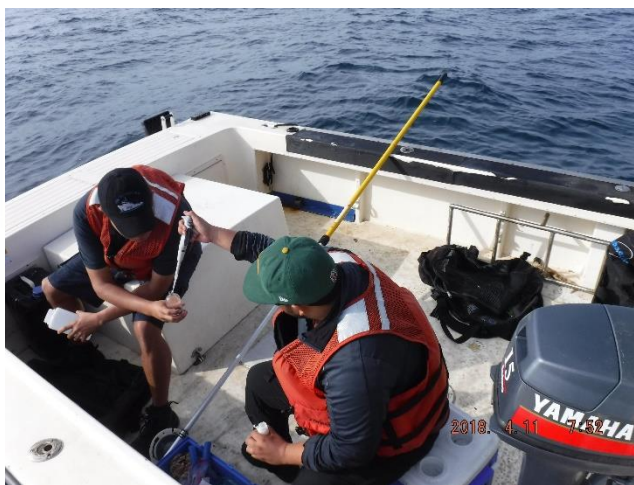
Figura 7.- Colocando agente estabilizador a la muestra de agua de mar.
