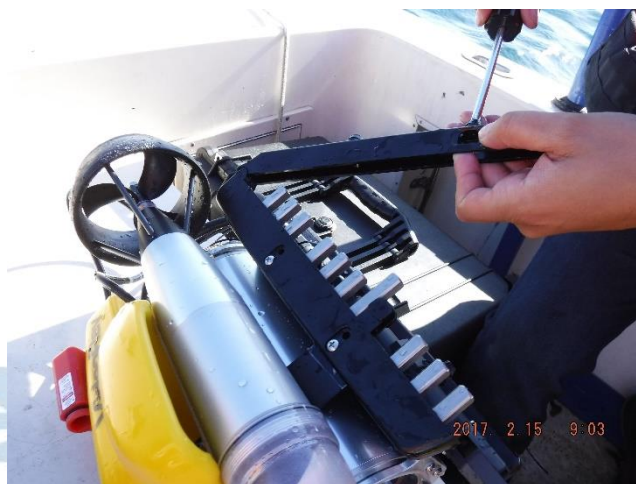
Figura 7.- Compartimento para pesos del ROV.
