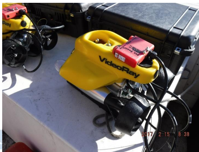
Figura 5.- LASER Sea Beam en la parte superior del ROV.
