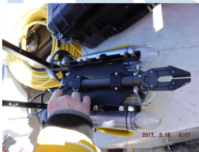
Figura 4.- Brazo manipulador instalado en parte inferior del ROV VideoRay Pro 4 .
