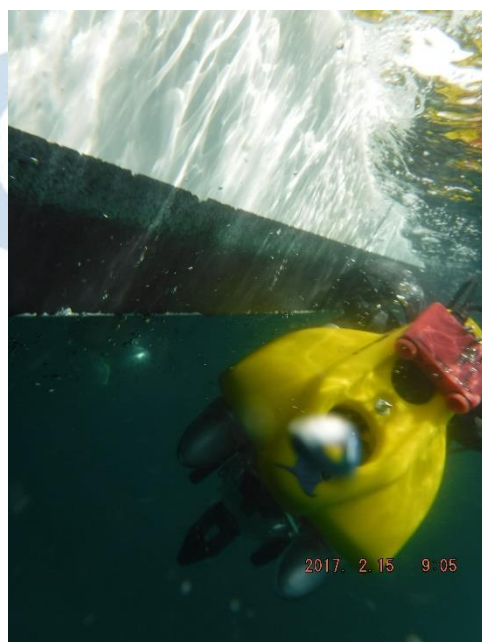
Figura 6.- ROV bajo el agua por la banda de babor de la Rigel , no energizado, probando flotabilidad.
