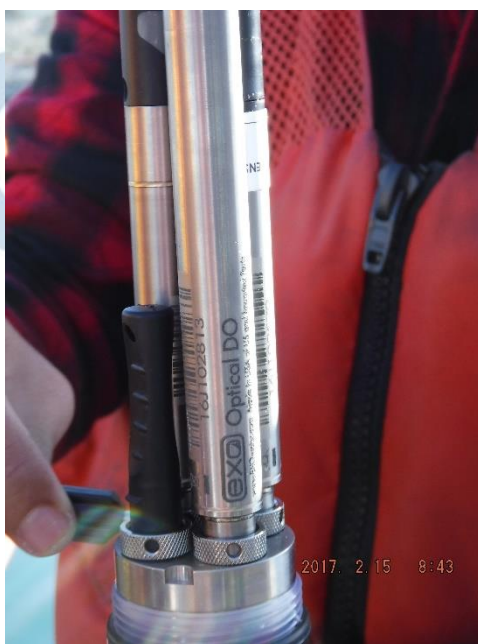
Figura 12.- Sensor EXO Optical DO instalado en cabezal de sonda YSI EXO 1 .
