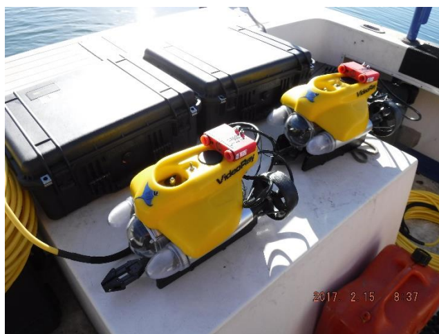
Figura 1.- ROVs VideoRay Pro 4 a bordo de la Rigel.
