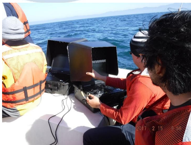
Figura 8.- Las dos consolas de control de los ROVs en cubierta de la Rigel .
