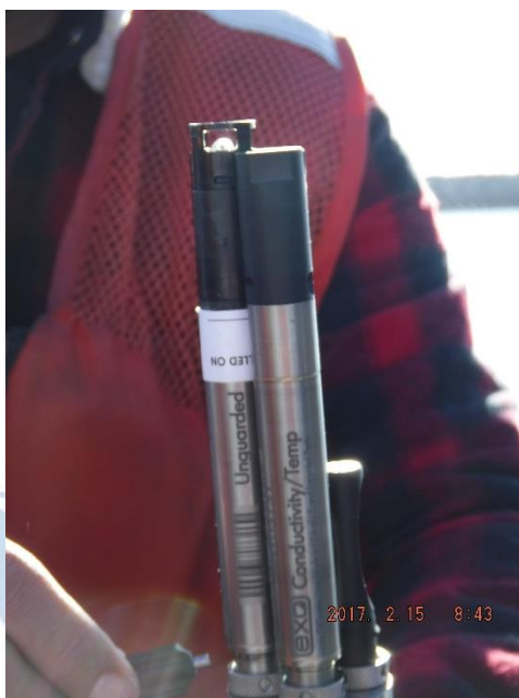
Figura 11.- Sensor EXO Conductivity / Temp en cabezal de sonda YSI EXO 1 .
