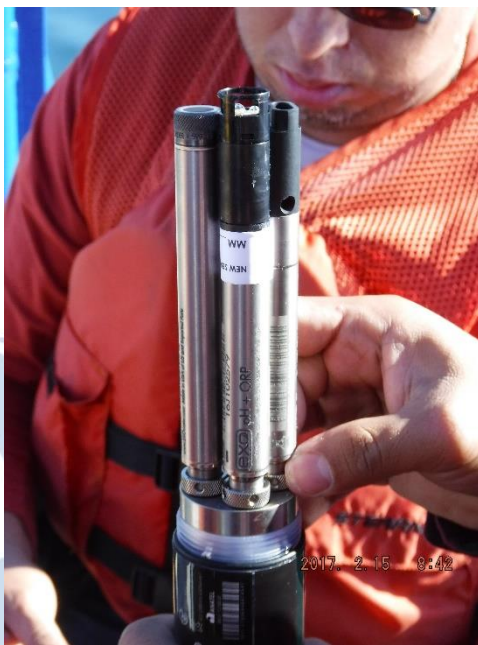
Figura 10.- Sensor EXO pH + ORP instalado en cabezal de sonda YSI EXO 1.
