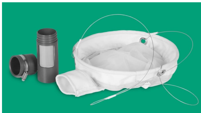
Fig. 3.- Red Cónica para fitoplancton.
