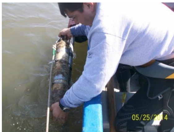
Figura 8A.- Recuperación de sensor SBE en la cabecera del EPB.
