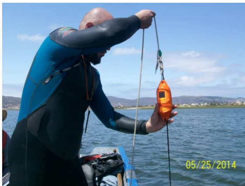
Figura 10.- Investigador perfilando la columna vertical del agua con CTD en una de las estaciones.
