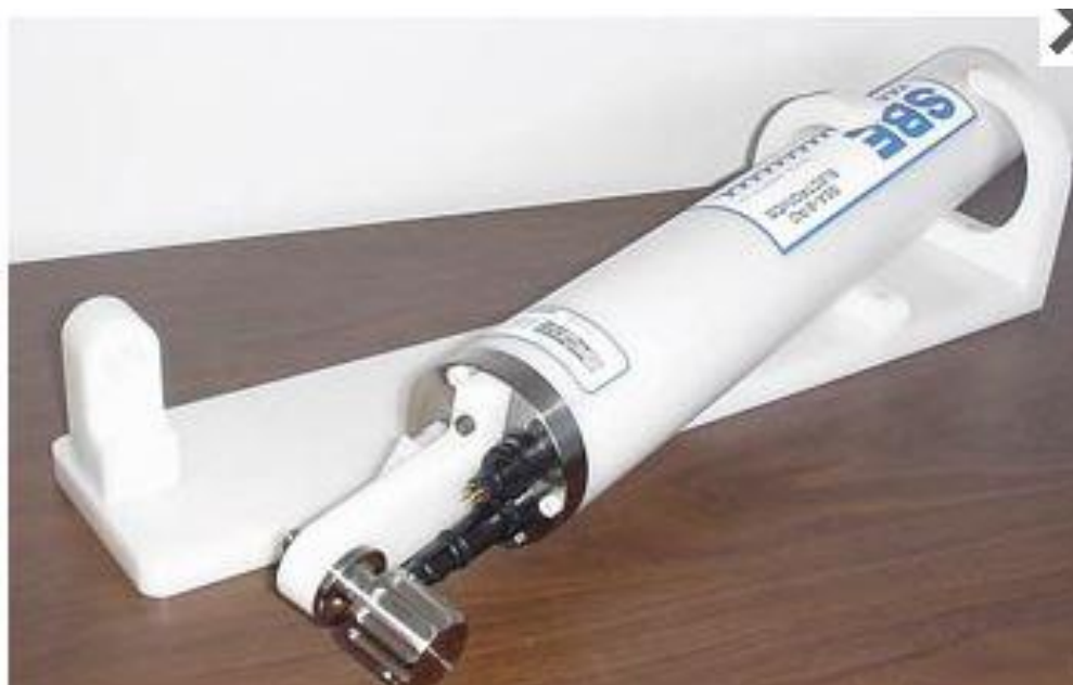
Figura 3.- Sensor Seabird electronics modelo SB26.
