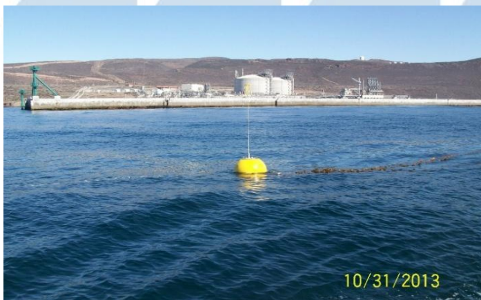
Fig. 16.- Boya Datawell instalada en ECA.
