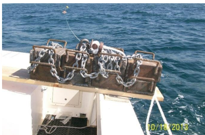
Fig. 18.- Se observa el peso muerto fraccionado.
