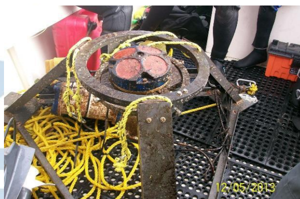
Fig. 8.- ADCP recuperado del fondo marino.
