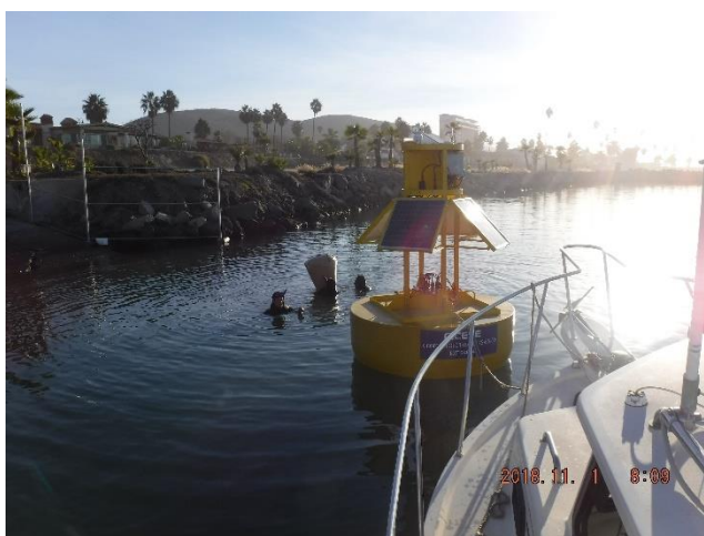
Figura 3.- BOC2 y cadena de fondeo a flote. La cadena de fondeo flota con apoyo de boya de salvataje.
