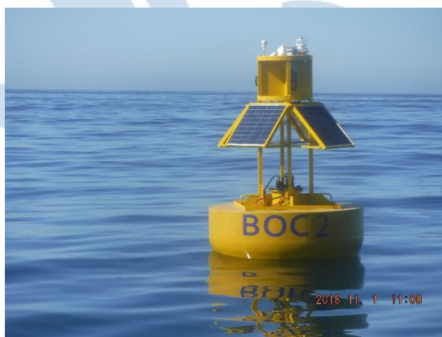
Figura 9.- BOC2 instalada en sitio costero de pruebas.
