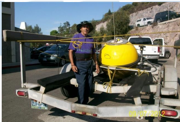
Fig. 7.- Boya Datawell sobre el remolque.
