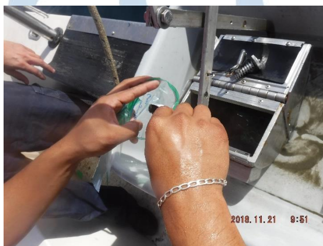
Figura 6.- Recolectando muestra para granulometría de la draga Petite Ponar .
