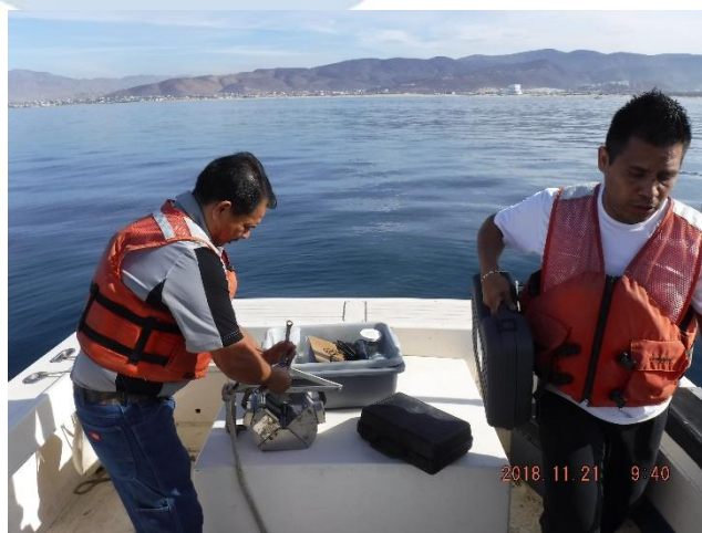
Figura 4.- Preparando la draga Petite Ponar para lances.
