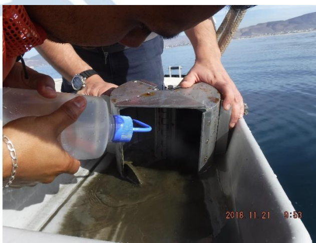
Figura 7.- Despegando el sedimento de las paredes de la draga.
