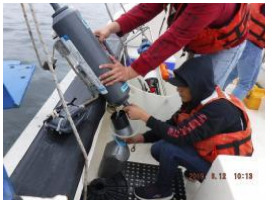
Fig.8.- Filtrando el agua de la botella Niskin .
