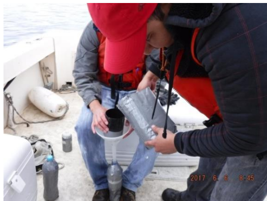
Fig. 9.- Filtrando el agua superficie con tamiz de 147 micras.
