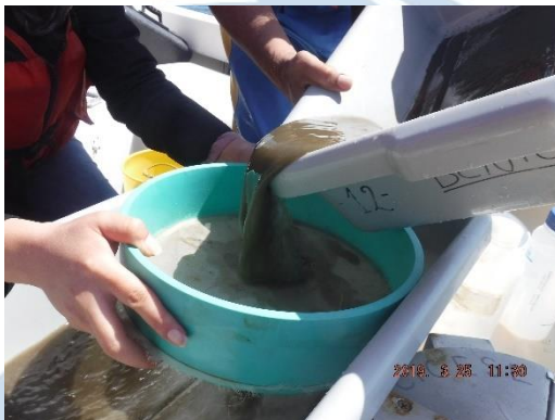
Fig. 28.- Tamizando el sedimento.
