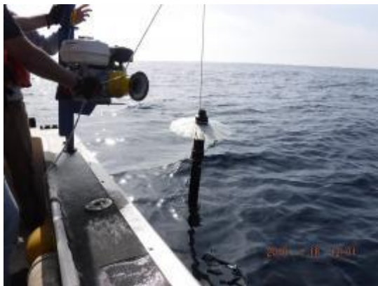
Fig. 12. VMP-250 colocado en superficie. Fig. 13. Se observan las cerdas circulares.
