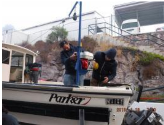
Fig. 2. Se observa el montaje del malacate en el pescante.
