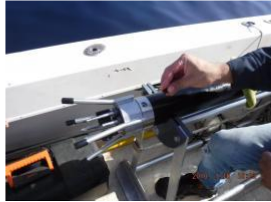
Fig. 10. Enroscando el tornillo imantado. Fig. 11. Se activó el perfilador VMP.
