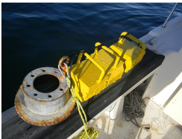
Figura 3.- Peso muerto de referencia (izquierda) y tres pesos muertos para el anclaje (derecha, amarillos) antes de lanzarlos al agua.
