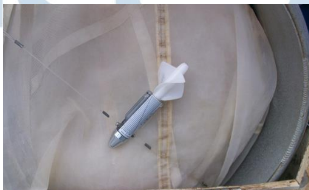
Fig. 5.- Flujómetro al centro de la red.
