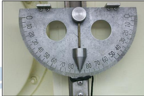
Fig. 6.- Inclinómetro para medir el ángulo de arrastre.
