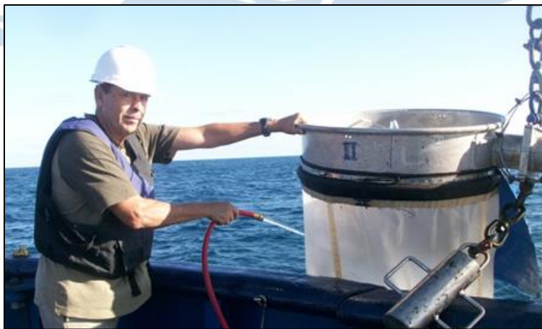
Fig. 9.- Lavado de redes con agua de mar a presión.
