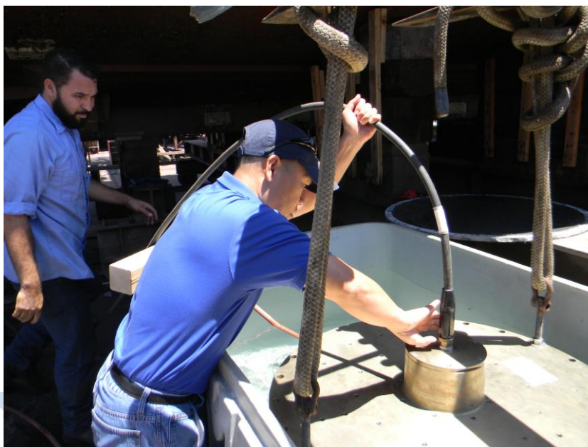
Figura. 4.- Tony Phakonekham revisando conexión del cable propietario al transductor del ADCP previo a las pruebas antes de su colocación en el nicho.
