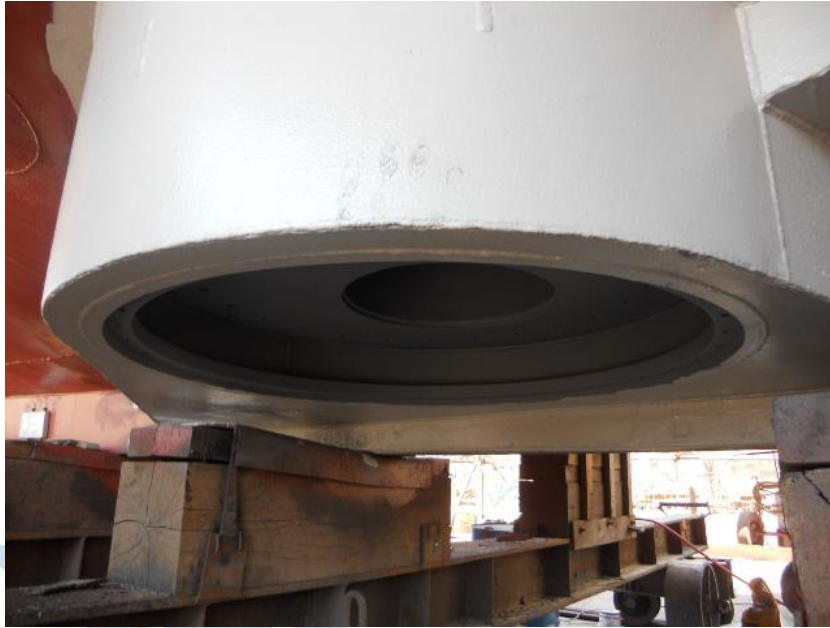
Figura. 3.- Nicho para el ADCP en el Buque Oceanográfico Alpha Helix , instalado en agosto 2014. El nicho se encuentra entre las cuadernas 18 y 20, de forma circular.
