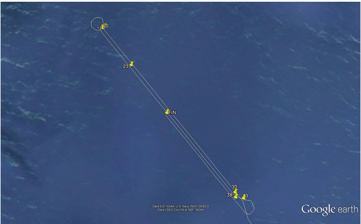
Figura. 17.- Se requirieron dos transectos completos y un tercer transecto a la mitad para realizar la prueba de alineación del transductor del ADCP.
