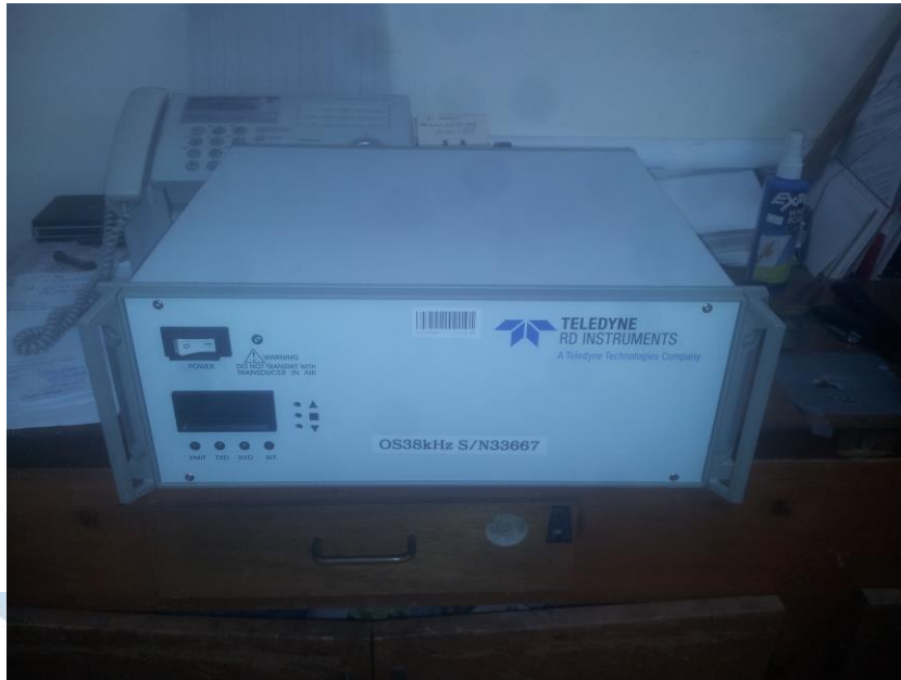
Figura. 2.- La unidad de control ( deck unit ) del ADCP, vista de frente. A través del cable propietario, esta unidad provee la alimentación eléctrica al transductor y comunicación bidireccional con el mismo.
