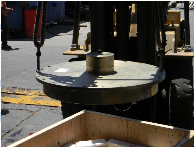
Figura. 1.- El transductor del ADCP OS38. Carcasa de bronce grado marino. En la parte superior se encuentra la circuitería y el conector para el cable propietario.
