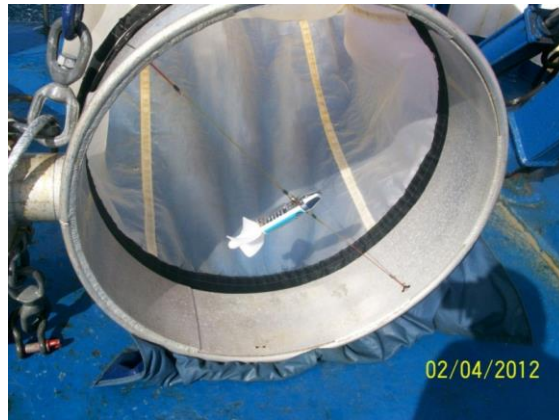
Fig. 4.- Muestra la ubicación del flujómetro al centro de la red.
