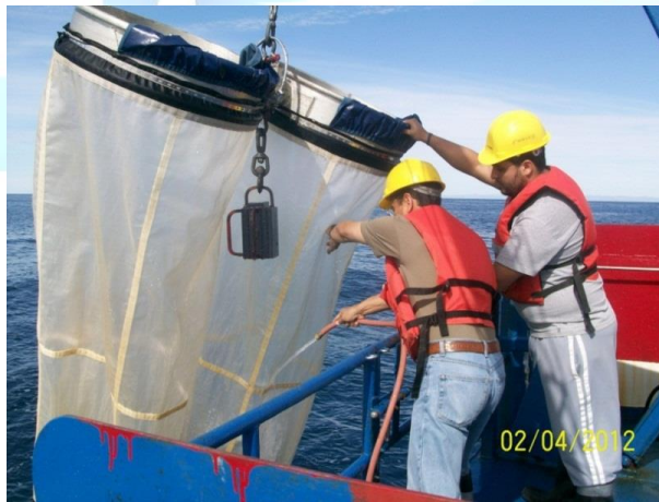
Fig. 8.- Lavado de redes después de realizar el arrastre.
