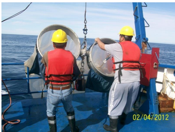
Fig. 7.- Arrastre de la red Bongo de 500 micras.
