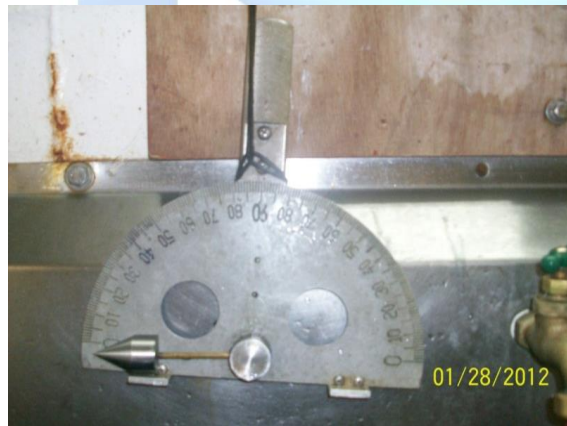
Fig. 5.- Clinómetro para medir el ángulo de arrastre.
